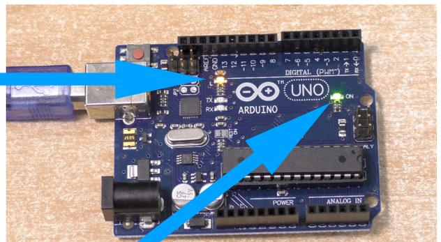
Diese LED leuchtet, sobald der Arduino mit Strom versorgt wird.
