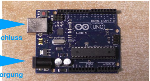
Es muss nur das USB - Kabel angeschlossen werden. Für unsere ersten Versuche genügt die Stromversorgung über den USB - Anschluss.
